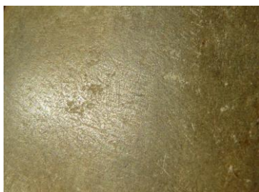
Fig. 12 : Glacis dû à l'affûtage d'outils métalliques
