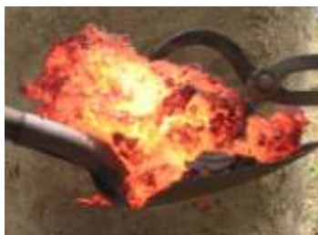
Figure 3 : Masses brutes de métal produites en bas fourneau. A gauche, une reconstitution ; à droite : un exemple archéologique (masse de l'Âge du fer trouvée dans une cave à Bourges)
