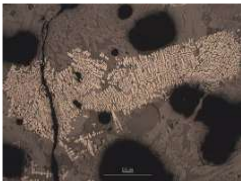
Figure 32 : Battiture tombée dans la scorie liquide au fond du foyer de forge. Elle a été figée alors qu'elle était en cours de fusion
