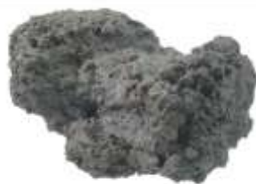
Figure 3 : Masses brutes de métal produites en bas fourneau. A gauche, une reconstitution ; à droite : un exemple archéologique (masse de l'Âge du fer trouvée dans une cave à Bourges)
