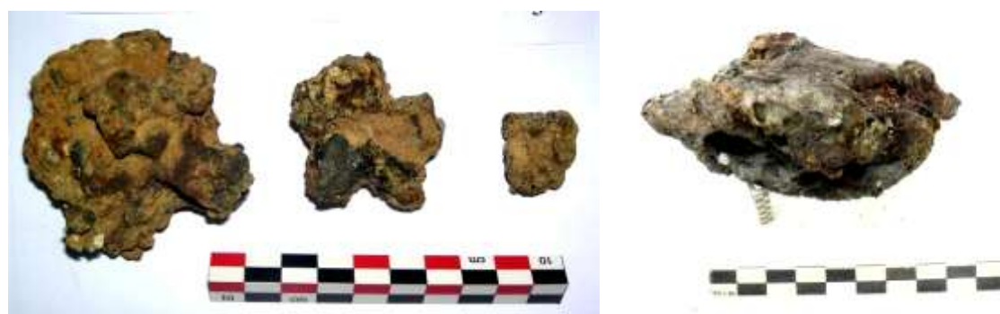
Figure 30 : Scories argilo-sableuses de forge
