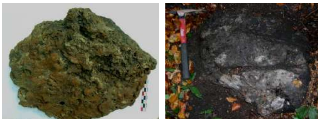
Figure 25 : Laitiers de haut fourneau produits aux environs du XVI e -XVII e siècle
