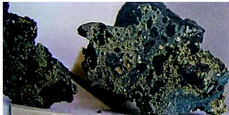
Figure 27 : Laitier de bas fourneau d'Oulches (tiré de Mahé-Le Carlier 1997)
