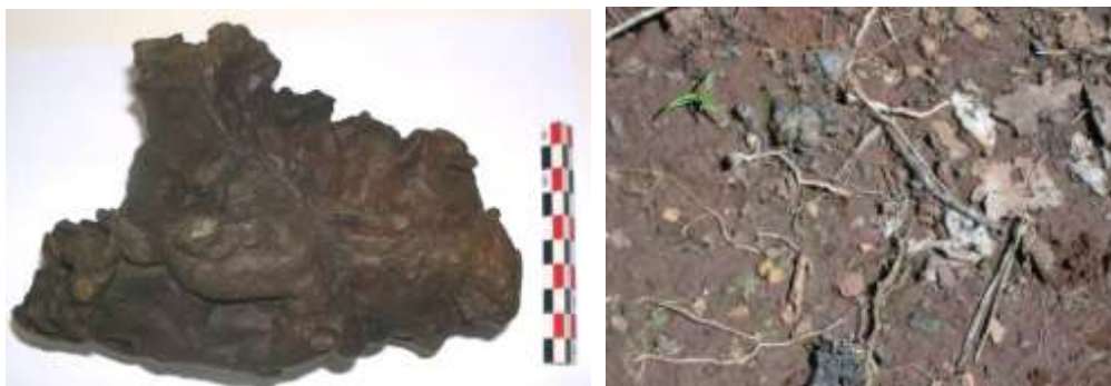
Figure 20 : Coulures de scorie piégée que l'on peut retrouver dispersées en surface
