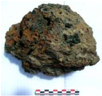
Figure 26 : Laitier de haut fourneau avec gros charbon de bois produits aux environs du XVI e -XVII e siècle
