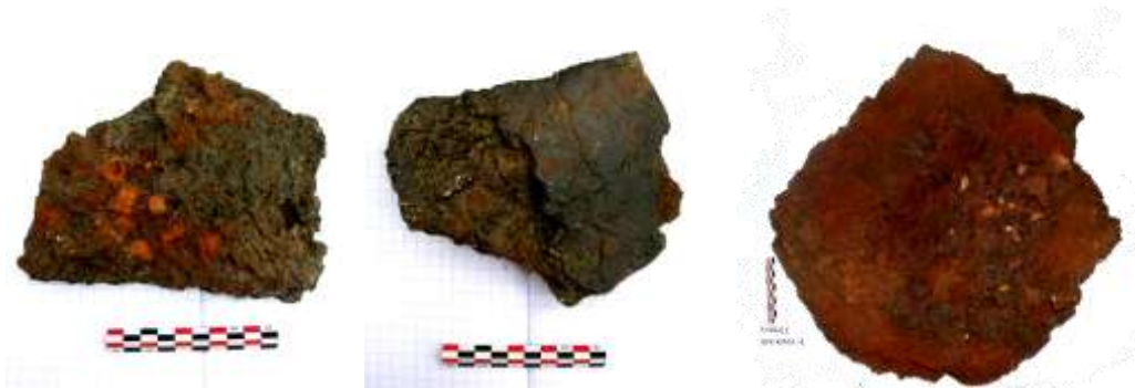
Figure 28 : Scories d'affinage de gueuse de fonte
