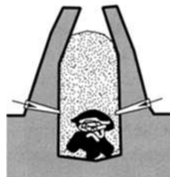
Figure 5 : Schéma d'un four à scorie piégée (tiré de Serneels 1998)
